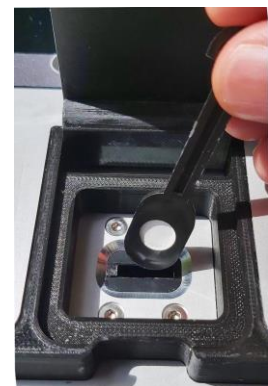
Filterstreifen mit Probenwasser wird mit dem 10cells in nur wenigen Sekunden analysiert
