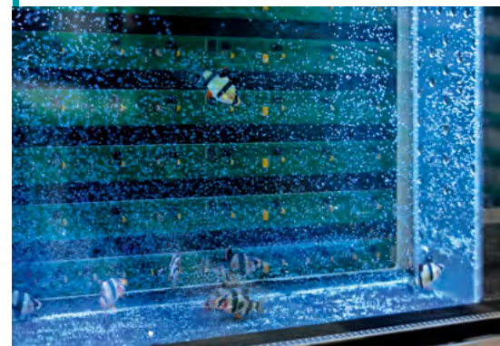
Das ToxProtect II überwacht die Schwimmaktivitäten von Fischen in einem vom Trink- oder Leitungswasser durchströmten Aquarium.
