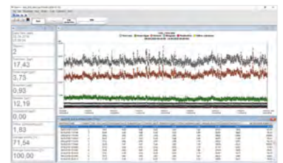
Screenshot der mitgelieferten und vorinstallierten bbe-Software für den AlgaeOnlineAnalyser zur Darstellung und Analyse der Messdaten.
