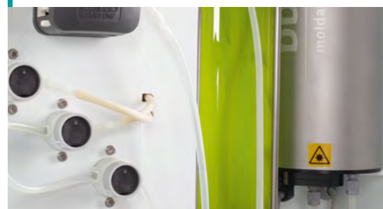
Amostra de água é misturada com solução de teste de alga para ser analisada em seguida.
