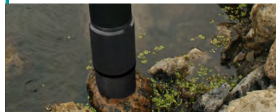
O BenthoTorch em utilização na medição de classes de algas e sua concentração em uma superfície de pedra.
