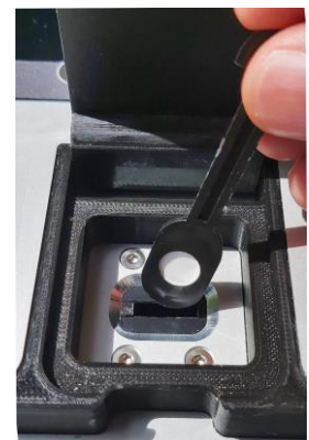
La tira de filtro con la muestra de agua se analiza en pocos segundos
